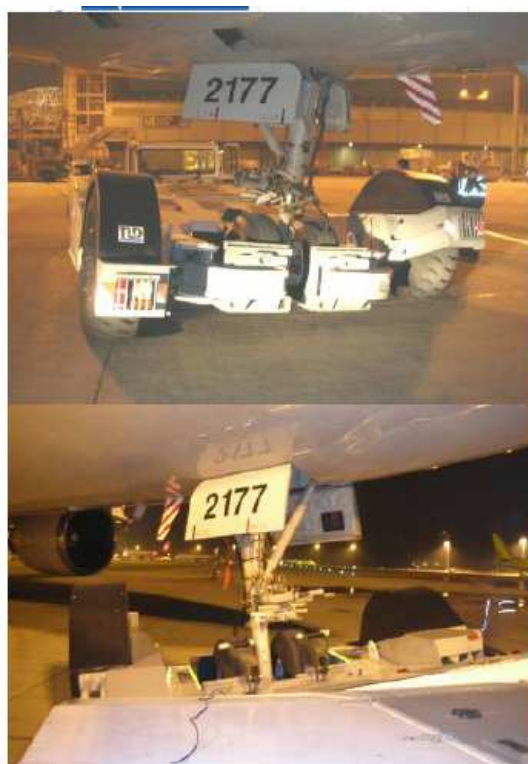
Letiště Leoše Janáčka Ostrava, Stroje a zařízení II – „Towbarless pushback tractor“
