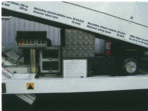
Detailní pohled na motorovou a hydraulickou část včetně ovladačů stabilizátorů, osvětlení a zdvihu.
